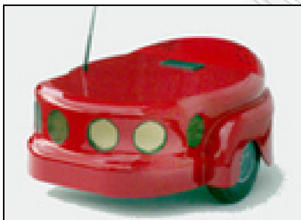
Εικόνα 4.1: Η βασική έκδοση του AmigoBot με την κεραία ασύρματης επικοινωνίας προσαρμοσμένη στο επάνω μέρος του.
