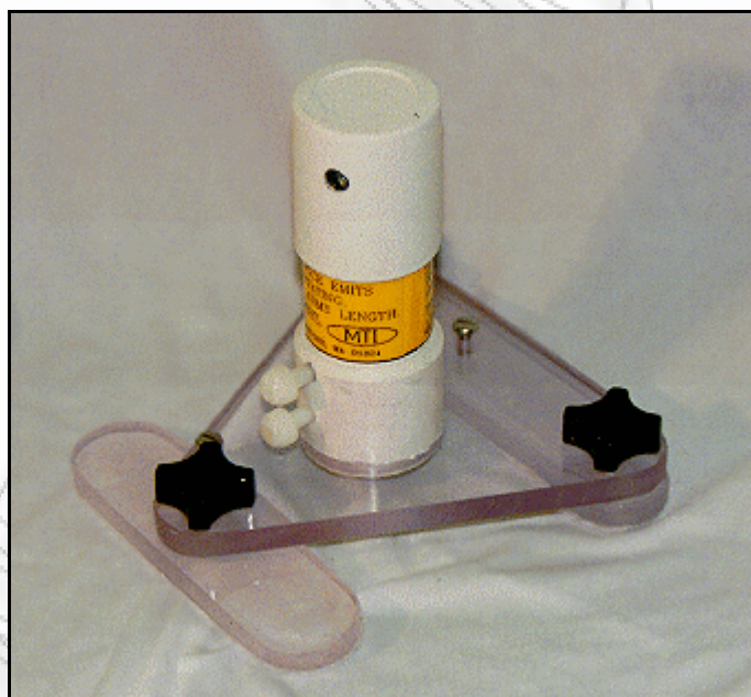
Εικόνα 3.2: Ένα και μόνο STROAB διαθέτει ένα λέιζερ κάθετης διασποράς ενώ περιστρέφεται με ταχύτητα 3000 στροφές/λεπτό
