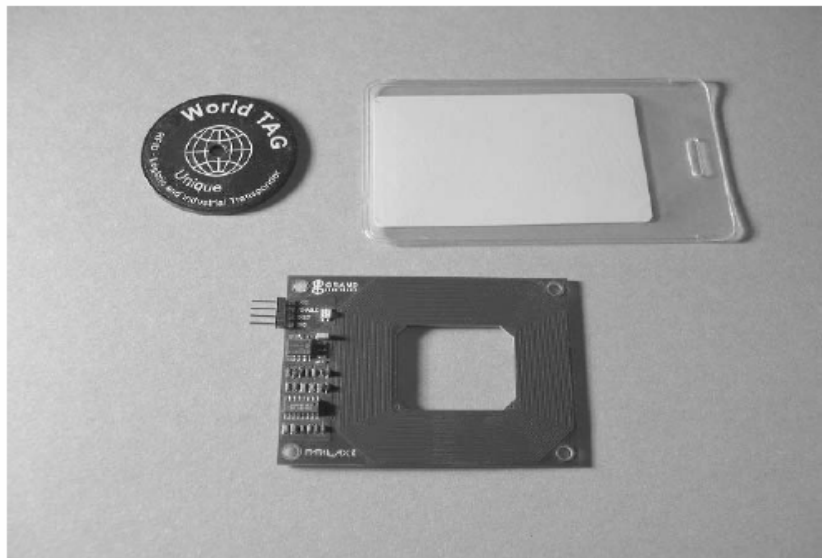
Σχήμα 2.7. Δυο διαφορετικά RFID tags και ένας reader μία ενσωματωμένη κεραία
