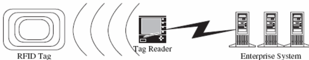
Σχήμα 2.1. Ένα τυπικό RFID σύστημα
