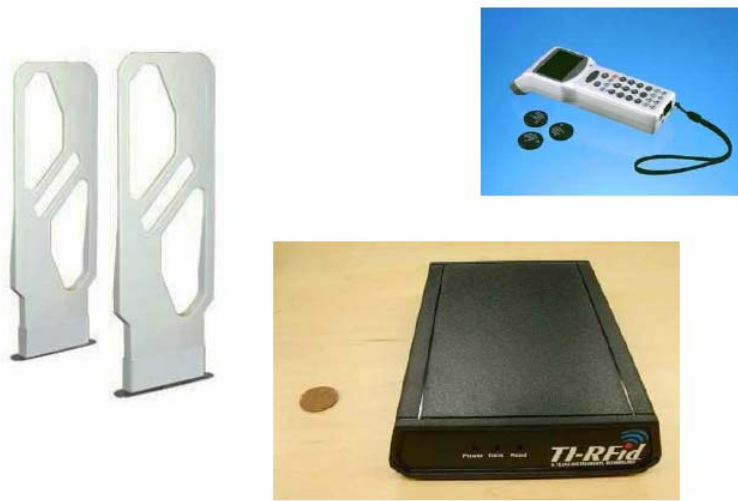
Σχήμα 2.2. RFID αναγνώστες (readers)
