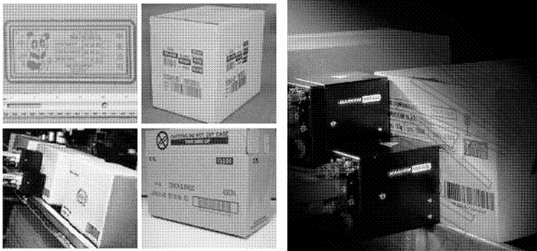
Σχήμα 25. Εκτυπωτής εκτόξευσης μελάνης (ink-jet) υψηλής ανάλυσης και δείγματα εφαρμογών
