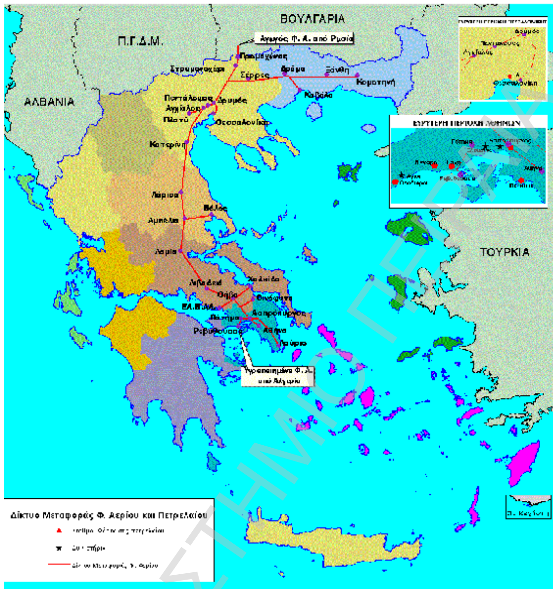
Σχήμα 3.2 Χάρτης εγκαταστάσεων και δικτύου μεταφοράς πετρελαίου/φυσικού αερίου [Πηγή: ΔΕΠΑ]
