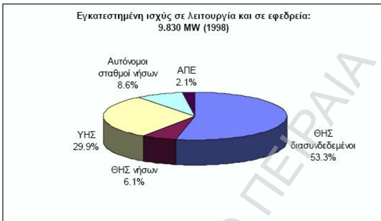
Σχήμα 4.6. Κατανομή της εγκατεστημένης ηλεκτρικής ισχύος. (1998) [12]
