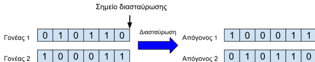
Εικόνα 179 Διασταύρωση ενός σημείο στο σημείο k
