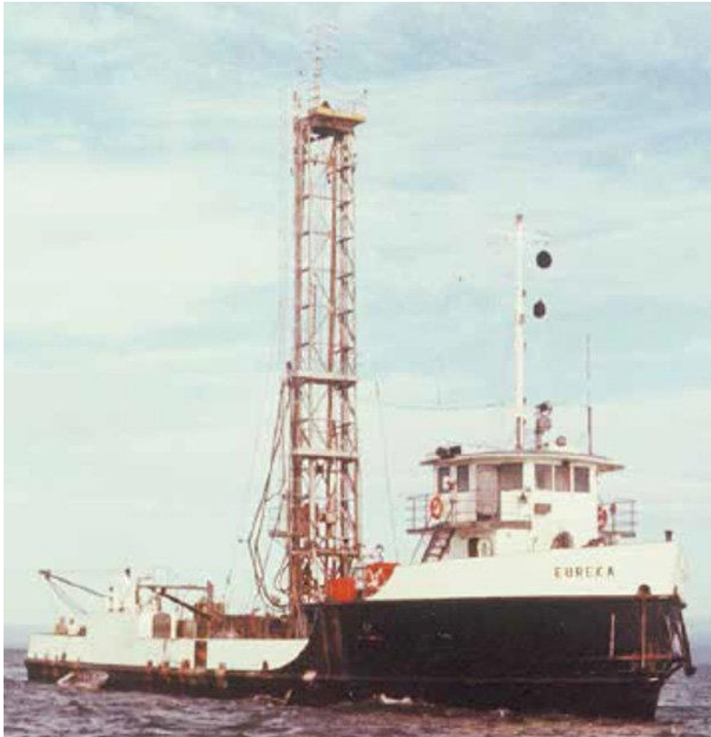
Εικόνα 1: Eureka, 1961. Το πρώτο πλοίο με τεχνολογία Dynamic Positioning
