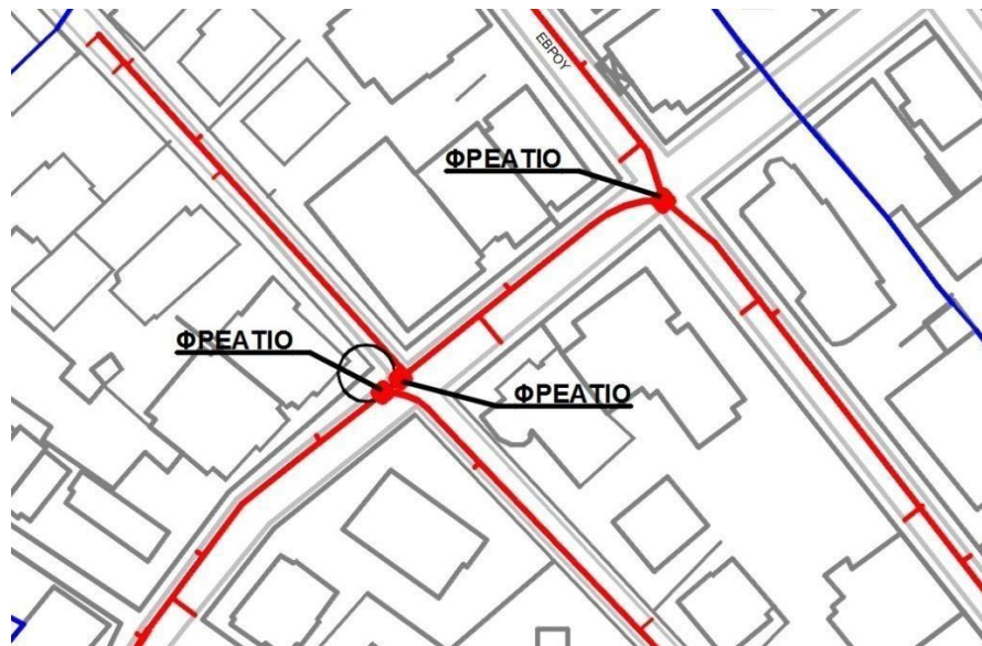
Εικόνα 5.8: 4 ο Βήμα: Τοποθέτηση φρεατίων
