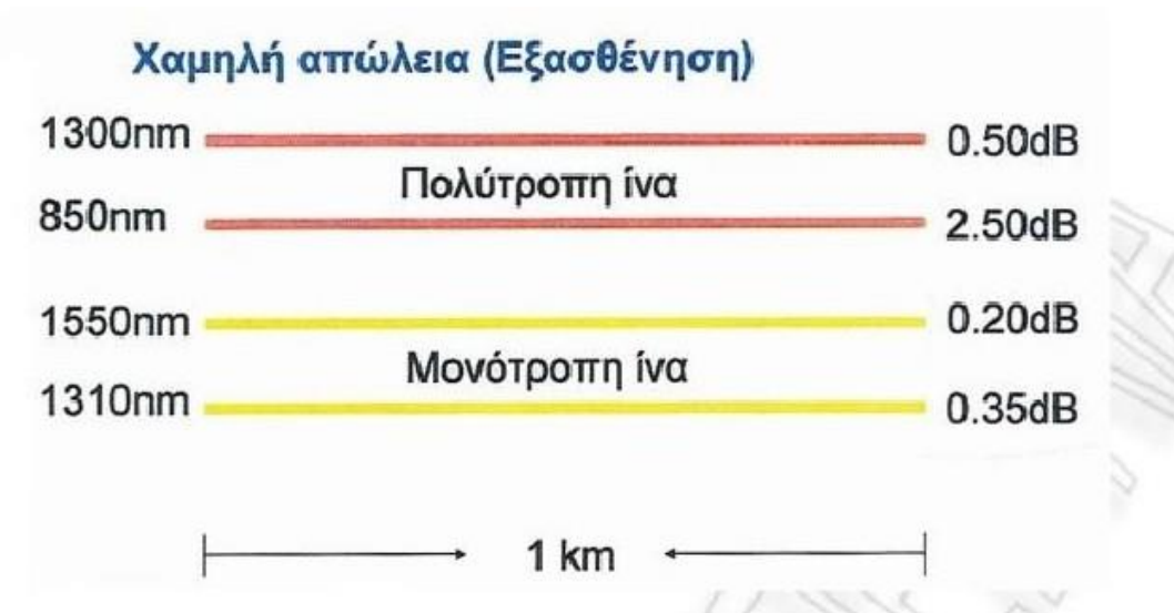
Εικόνα 2.3: Εξασθένηση σήματος (dB/km) σε μονότροπες και πολύτροπες ίνες, με παράμετρο τη διάμετρο πυρήνα
