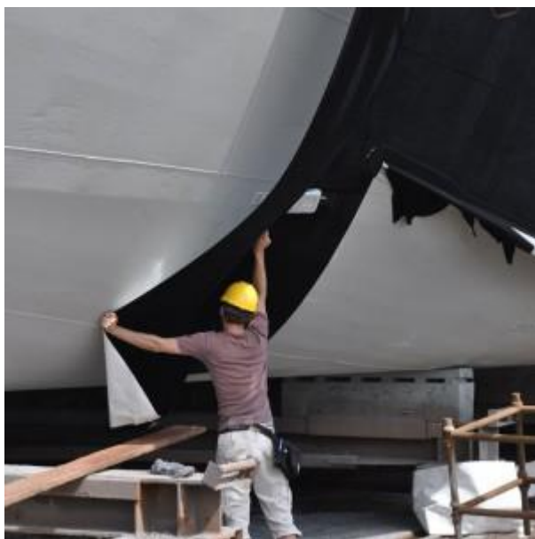
Εικόνα 8.3: Τοποθέτηση αντιρρυπαντικής μεμβράνης σε γάστρα πλοίου.
