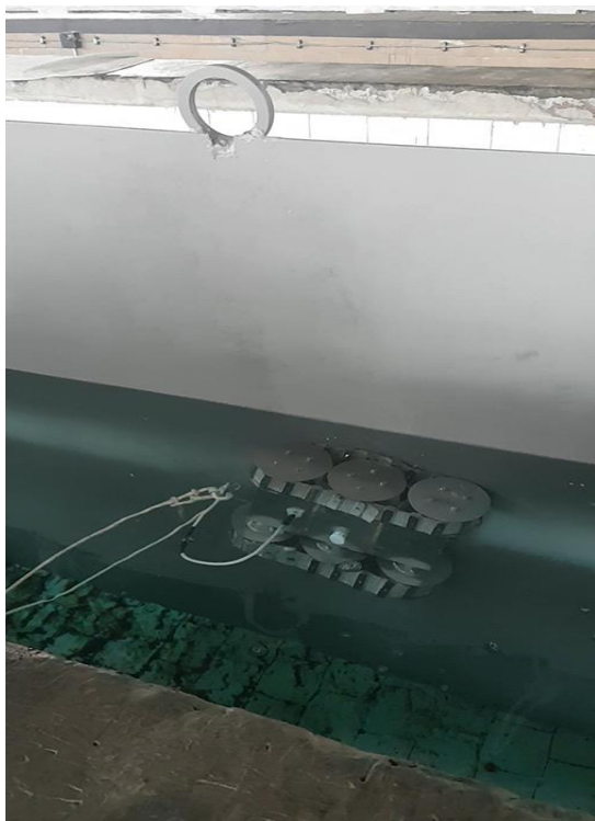
Εικόνα 6.3: Συσκευή υποβρύχιου καθαρισμού ARMUS δεύτερης γενιάς.
