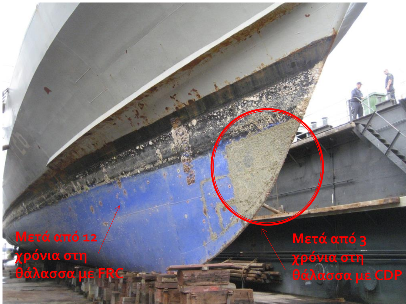
Εικόνα 2.1: Υφαλοχρώματα FRC και CDP στην ίδια γάστρα περιπολικού πλοίου.
