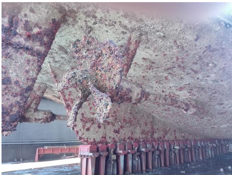
Εικόνα 1.2: Ανάπτυξη σκληρής ρύπανσης στις έλικες πλοίου. (πηγή: Προσωπικό αρχείο)
