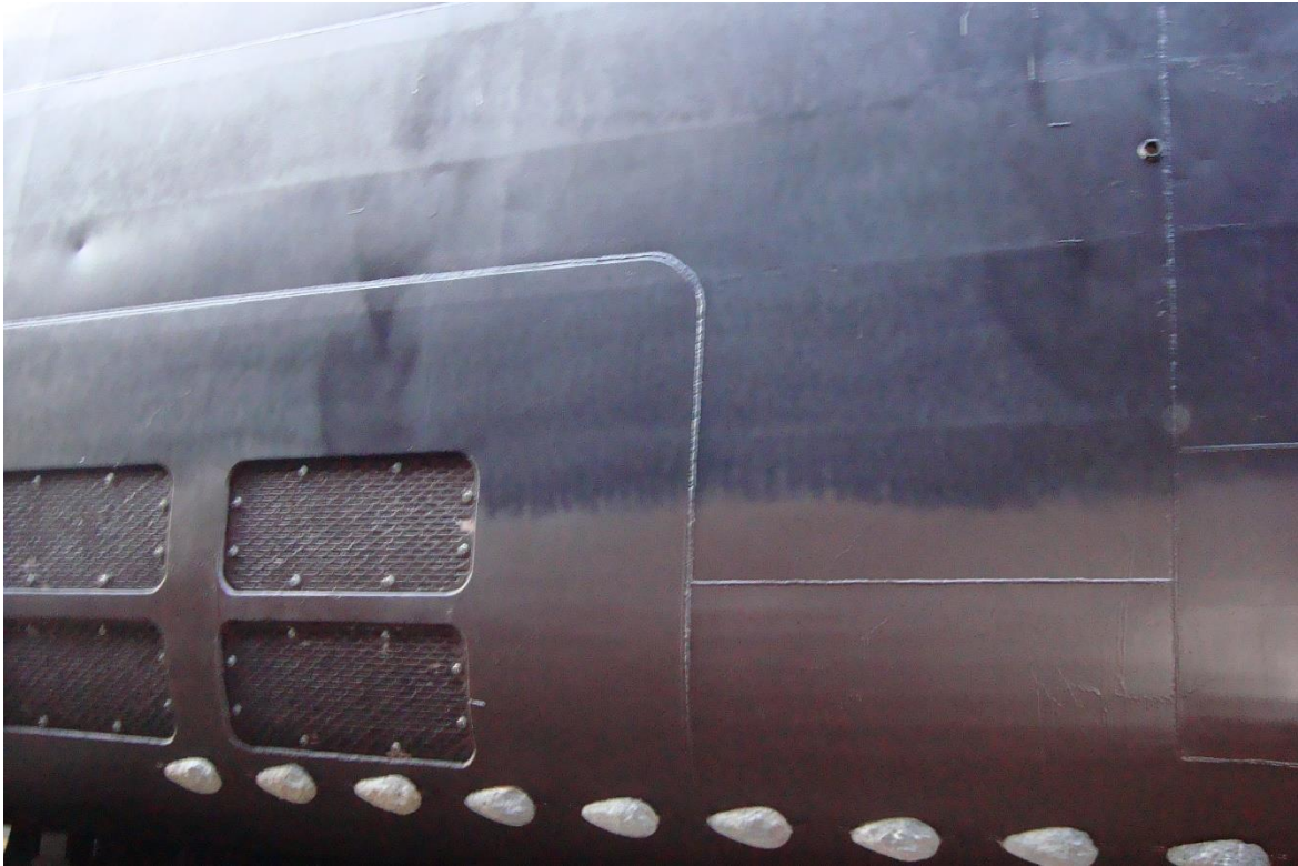
Εικόνα 7.2.: Ανόδια ψευδαργύρου σε ύφαλα πλοίου. (πηγή: Προσωπικό αρχείο)
