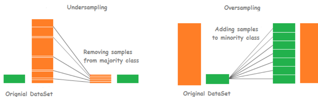
Εικόνα 12. Σχηματική αναπαράσταση της μεθόδου α) υποδειγματοληψίας και β) υπερδειγματοληψίας [69].
