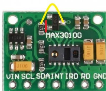
Εικόνα 50. Τροποποίηση αισθητήρα χωρίς την αφαίρεση των αντιστάσεων
