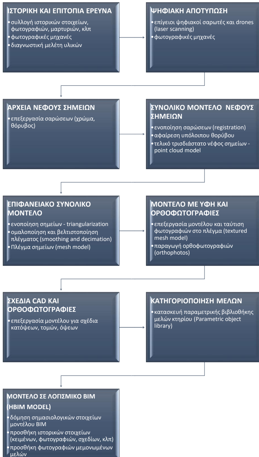
Εικόνα 15 Στάδια δημιουργίας μοντέλου BIM σε ιστορικές κατασκευές.
