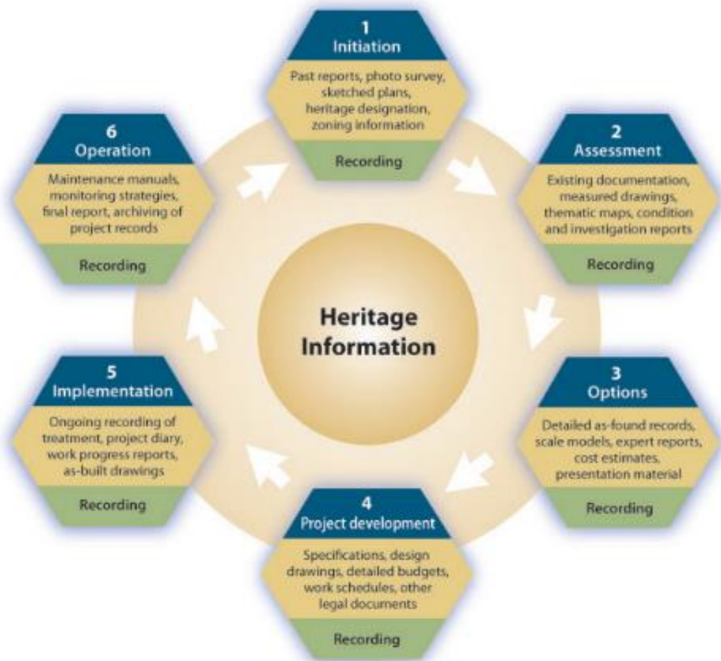
Εικόνα 14. Διάγραμμα φάσεων και απαιτούμενων αποτελεσμάτων σε μια μελέτη αποκατάστασης [27].
