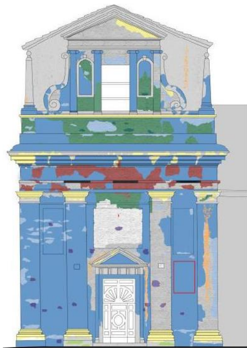
Εικόνα 20. Chiesa della Pietà στο Φέρμο της Ιταλίας. Κύρια όψη με χαρτογράφηση της παθολογίας και περιγραφικό υπόμνημα.
