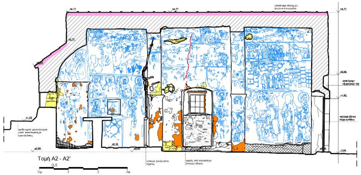
Εικόνα 60. Κατά μήκος τομή - Τεκμηρίωση και καταγραφή παθολογίας
