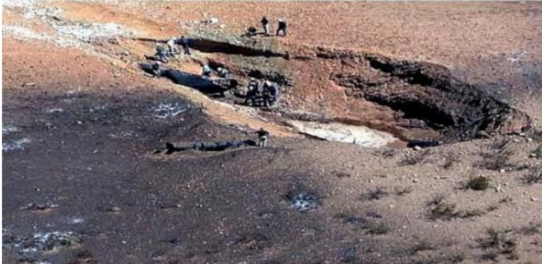
Εικόνα 11: Δημιουργία κρατήρα από την έκρηξη αγωγού μεταφοράς φυσικού αερίου (Πηγή: www.cnn.gr )
