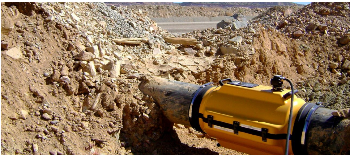
Εικόνα 21: Το ροόμετρο SONARtrac Model VF/GVF-100 της εταιρίας CIDRA (Πηγή: http://cloudseven.azurewebsites.net/cidra/Sonartrac.aspx )
