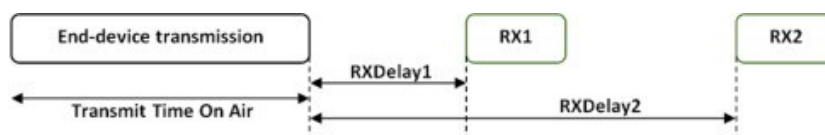
Εικόνα 36: Αμφίδρομη επικοινωνία μεταξύ τελικής συσκευής και σταθμού βάσης για κλάση LoRaWAN
