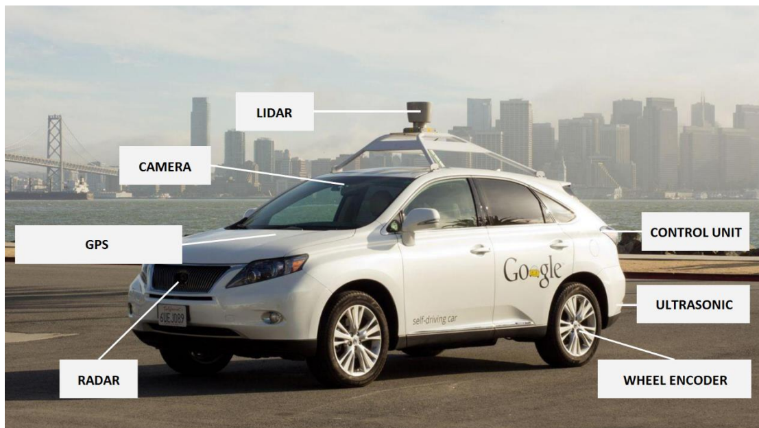
Εικόνα 3.1 Η δομή ενός αυτόνομου οχήματος. [26]
