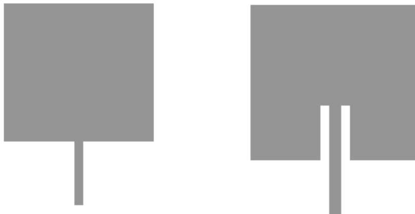
Σχήμα 2.14 Τροφοδοσία επιθέματος με μικροταινιακή γραμμή μεταφοράς, αριστερά χωρίς εσοχή, δεξιά με εσοχή.
