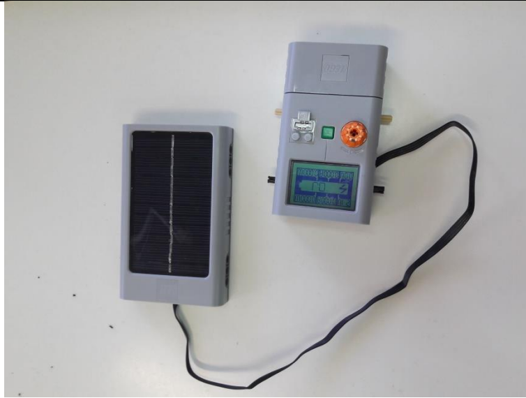
Εικόνα 17: Φωτοβολταϊκό στοιχείο και μετρητής
