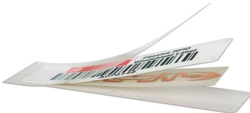
Σχήμα 3.10 Εφαρμογή της RFID τεχνολογίας στις σύγχρονες ανάγκες – χρήση παράλληλα με barcode για μεγαλύτερη ασφάλεια
