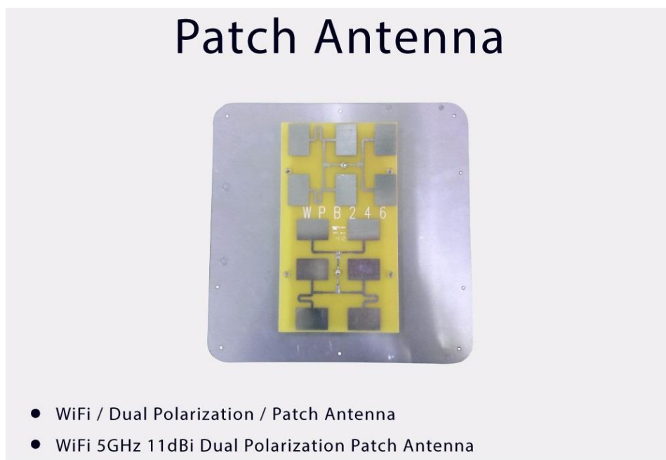
Σχήμα 3.12 Συστοιχία μικροταινιακών κεραιών διπλής πόλωσης για εφαρμογή σε Wi-Fi συστήματα
