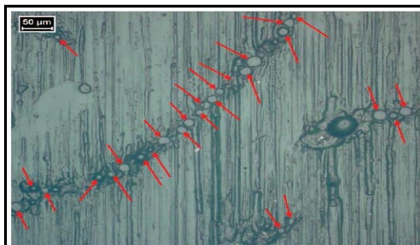
Εικόνα 31: Καταλυτικά σωματίδια που έχουν εισχωρήσει στην επιφάνεια κυλίνδρου από γραφίτη
