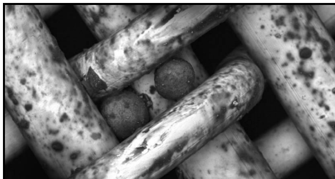
Εικόνα 33: Φίλτρο καυσίμου στο οποίο έχουν εισχωρήσει καταλυτικά σωματίδια
