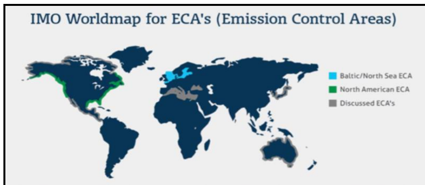
Εικόνα 17: Περιοχές ελέγχου εκπομπών επικίνδυνων οξειδίων από τα πλοία SECAs και περιοχές που αναμένεται να συμπεριληφθούν στη ζώνη των SECAs
