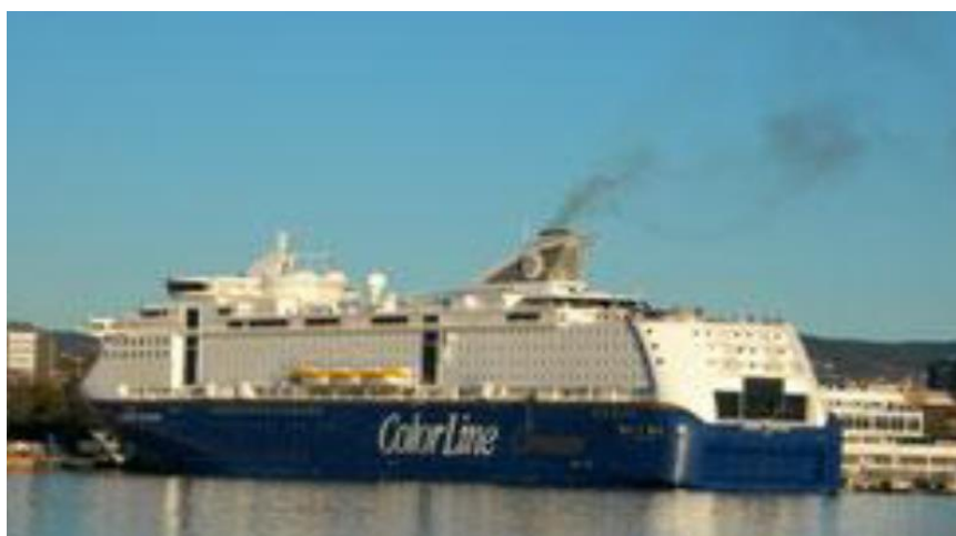
Εικόνα 1. 1 Ελλειμνισμένο κρουαζιερόπλοιο στο Όσλο, Νορβηγία, διακρίνεται ο μαύρος καπνός που παράγεται από τις ηλεκτρομηχανές του πλοίου οι οποίες τροφοδοτούνται με ντίζελ, MGO. Οι εκπομπές καυσαερίων στον αέρα προσκρούουν με τον καθαρό ατμοσφαιρικό αέρα των φιορδ που έχουν πρόσφατα οριστεί ως Παγκόσμια Κληρονομιά τόπων
