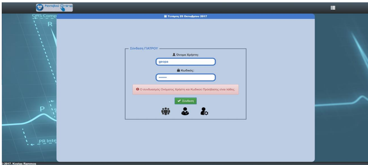
Εικόνα 2.17: Διεπαφή γιατρού – Οθόνη σύνδεσης με μήνυμα λάθους, αν τα στοιχεία δεν είναι σωστά.
