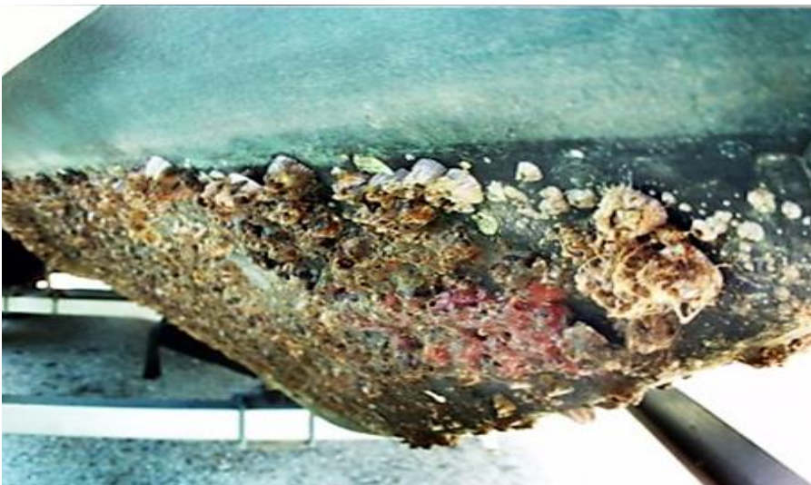
Σχ.1 Παράδειγμα βιοσυσσώρευσης στα ύφαλα των πλοίων ( The Content Philosopher, http://www.gollner.ca/ )
