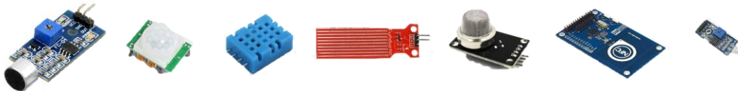
Εικόνα 12 - Περιφερειακά GPIO από αριστερά : αισθητήρας ήχου, κίνησης, θερμοκρασίας/υγρασίας, πλημύρας, καπνού, RFID, φωτός
