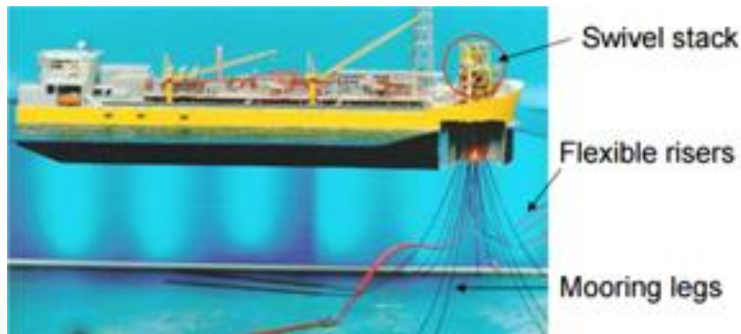
Εικόνα 13: Ολοκληρωμένο σύστημα SPM μεταφοράς LPG
