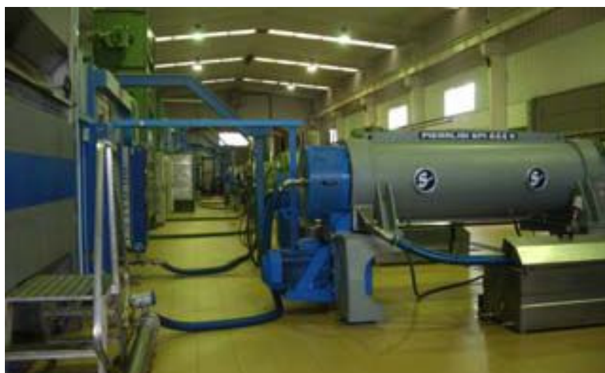
Εικόνα 5-8 Διαχωρισμός ελαίου και νερού με φυγοκεντρικό μηχάνημα
