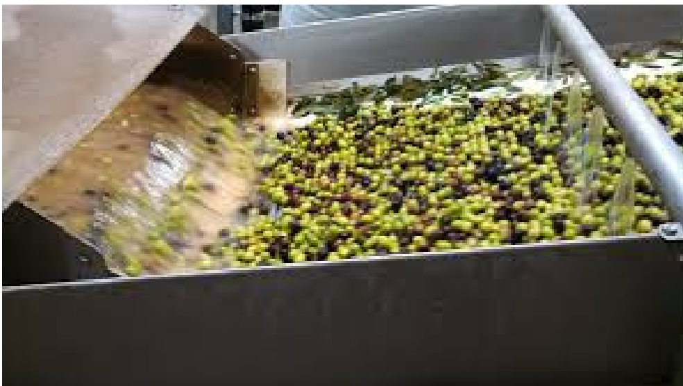
Εικόνα 5-4 Πλύσιμο του ελαιόκαρπου
