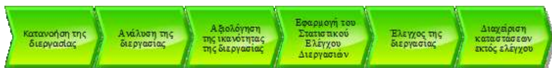
Σχέδιο 17: Διαδικασία εγκατάστασης Στατιστικού Ελέγχου Διεργασιών
