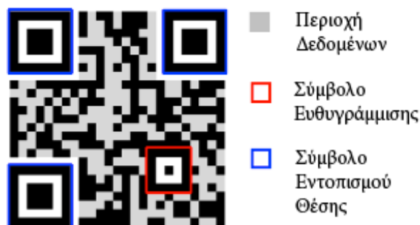
Εικόνα 16: Δομή ενός QR κώδικα.
