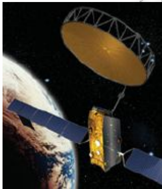
Εικόνα 1.4-1.5 Γεωστατικός δορυφόρος τύπου Inmarsat 4 και τερματικό BGAN νέας γενιάς (δεξιά) [13]
