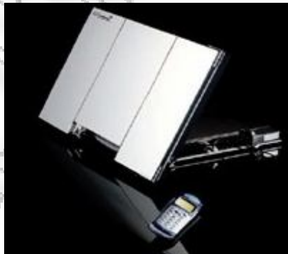
Εικόνα 1.4-1.5 Γεωστατικός δορυφόρος τύπου Inmarsat 4 και τερματικό BGAN νέας γενιάς (δεξιά) [13]
