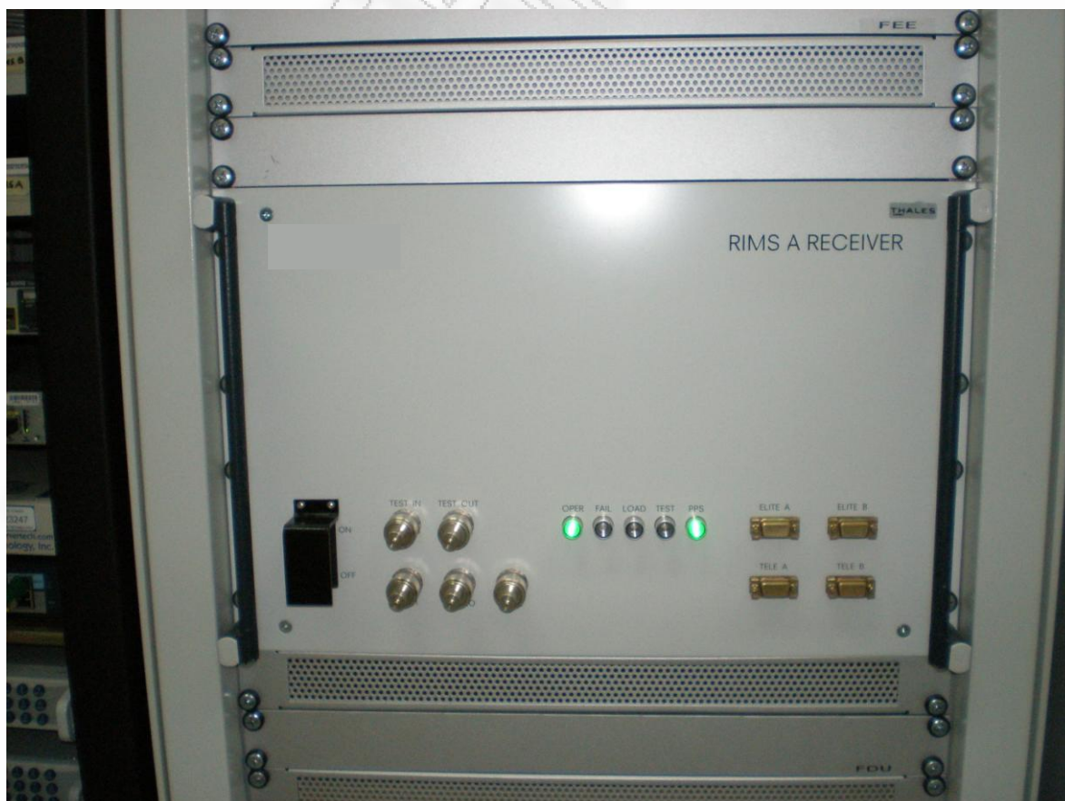
Στο κρύωμα του καναλιού RIMS A φαίνεται ο δορυφορικός GPS δέκτης του καναλιού αυτού.
