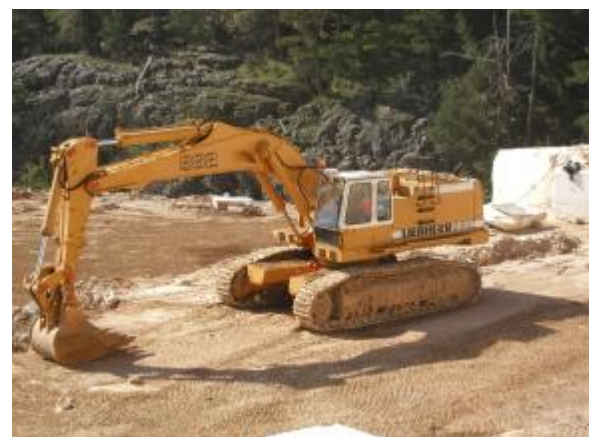
Εικόνα 12: Ερπυστριφόρα τσάπα τύπου Liebherr
