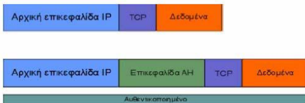
Εικόνα 10. Ενθυλάκωση της επικεφαλίδας AH στο πρωτόκολλο IPv4
