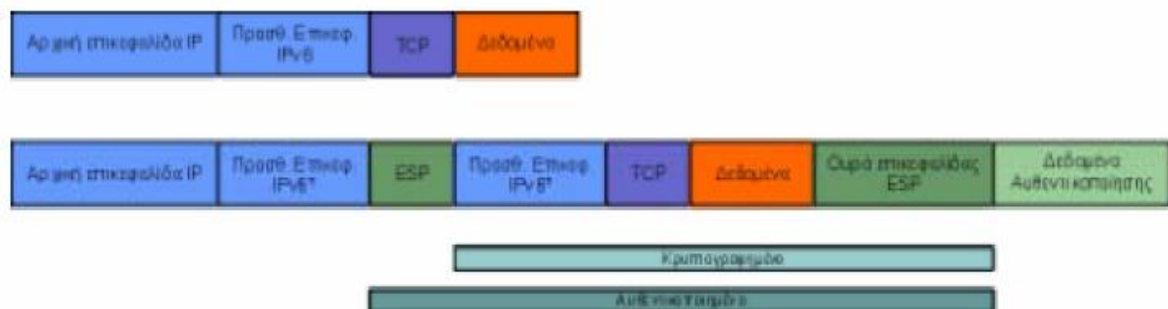
Εικόνα 14. Η θέση της επικεφαλίδας ESP σε IPv6
