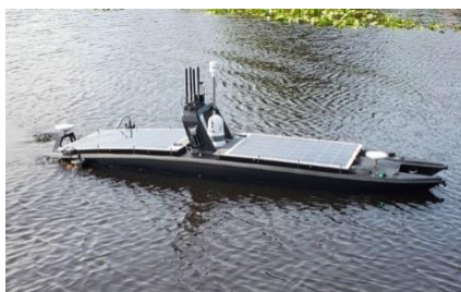
Εικόνα 17: USV solar and wind power
