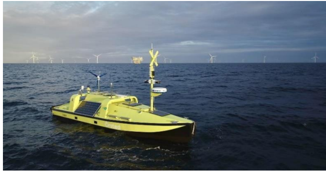
Εικόνα 2: Ørsted (USV Hugin μέτρηση – συλλογή δεδομένων Ωκεανών , Πηγή:
