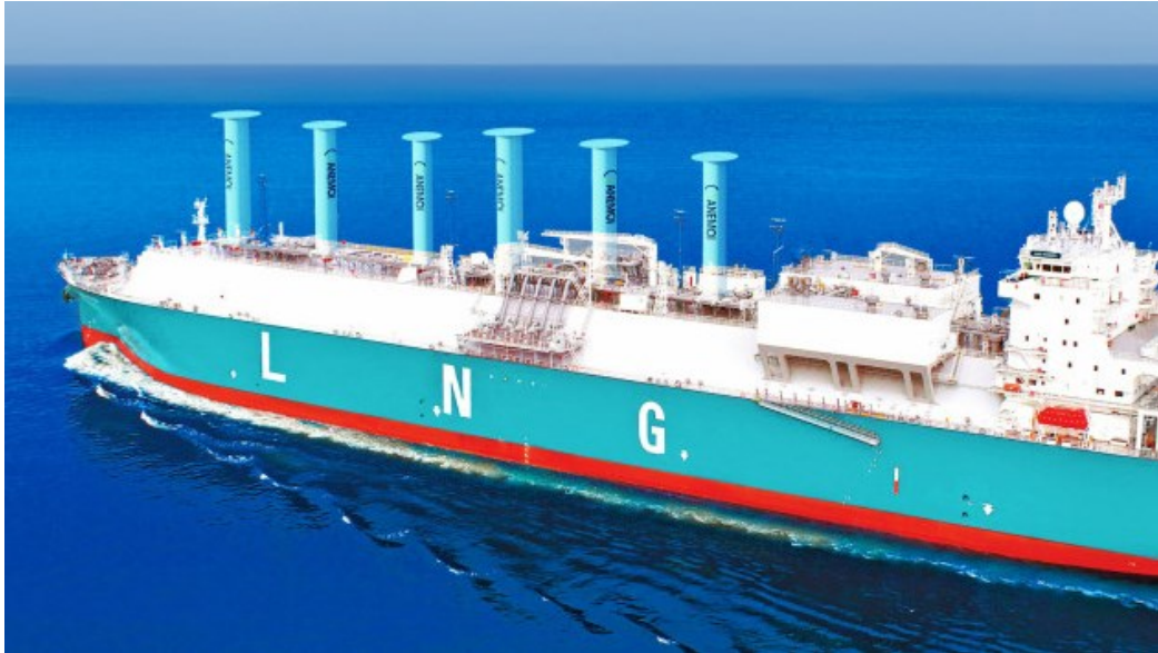
Εικόνα (17): Κάθετοι κύλινδροι Rotor Sails αξιοποίησης αιολικής ενέργειας 55 .
