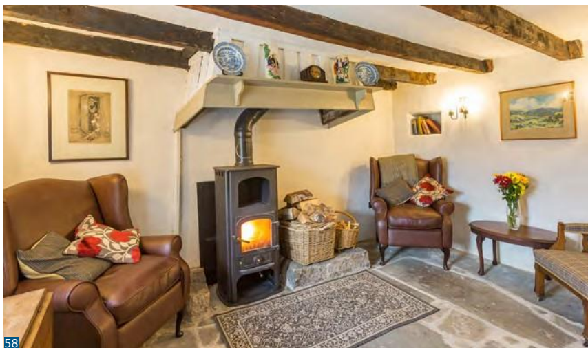
Εικόνα 58: Το τελειωμένο δωμάτιο στο Downie's Cottage δείχνει τον μονωμένο ασβεστοκονίαμα και το ξανατοποθετήθηκαν πέτρινες πλάκες.
