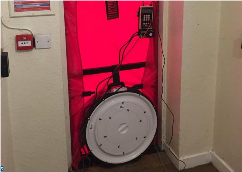
Εικόνα 9.2: Πραγματοποιείται δοκιμή πίεσης αέρα στο HolyroodParkLodge πριν από τις παρεμβάσεις.
