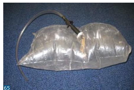
Εικόνα 65: Ένα μπαλόνι καμινάδας όπως χρησιμοποιείται για να κλείνει προσωρινά τους καπναγωγούς της καμινάδας
