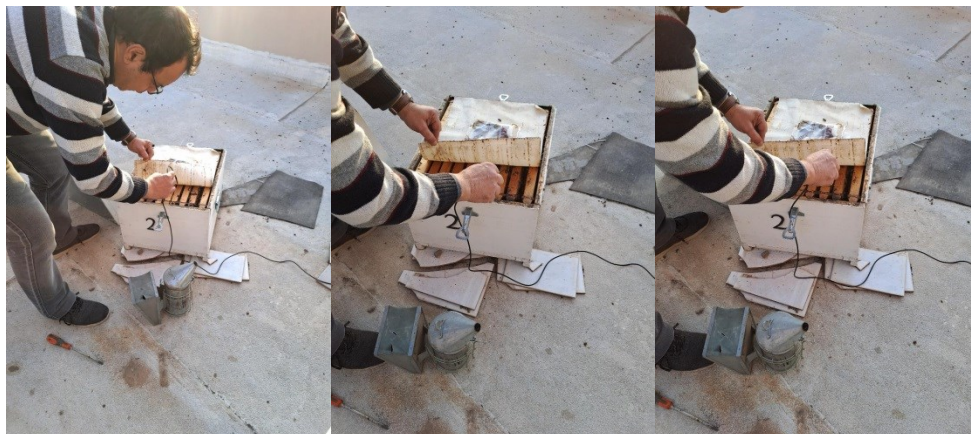
Εικόνα 7: Υλοποίηση συστήματος έξυπνης μελισσοκομίας - Τοποθέτηση αισθητηρίων θερμοκρασίας και υγρασίας στις κυψέλες
