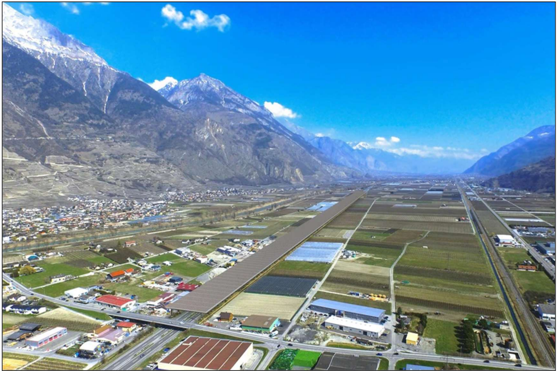
Εικόνα 23. Το πιλοτικό έργο αυτοκινητόδρομου με φωτοβολταϊκά κοντά στο Martigny στη νότια Ελβετία
