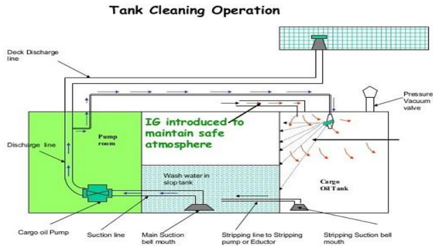
Εικόνα 10: Σύστημα καθαρισμού δεξαμενών με την χρήση αδρανούς αερίου
