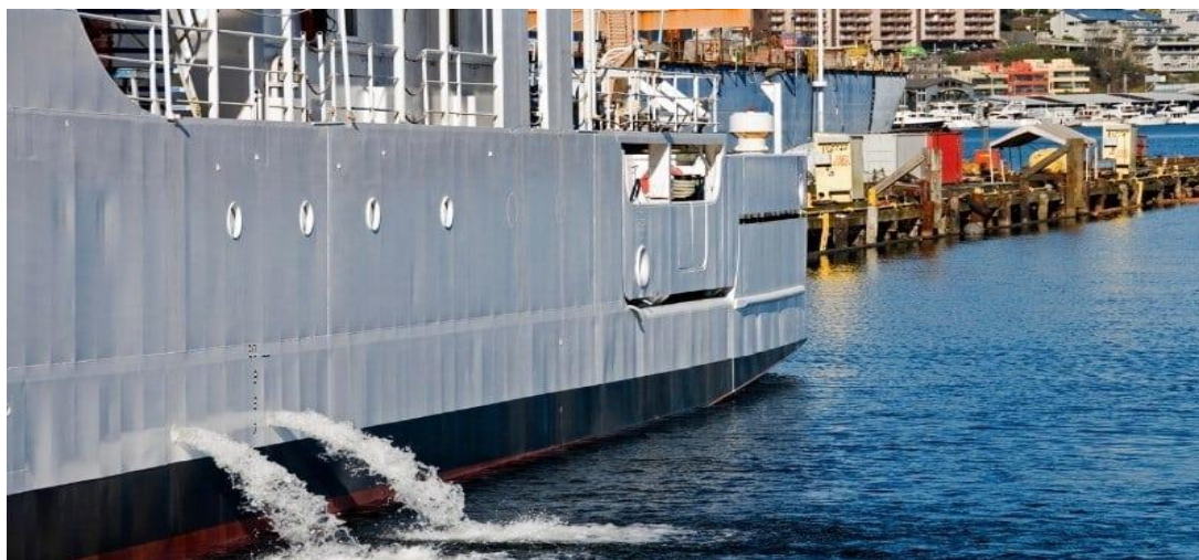
Εικόνα 15 – Εξαγωγή νερού έρματος
