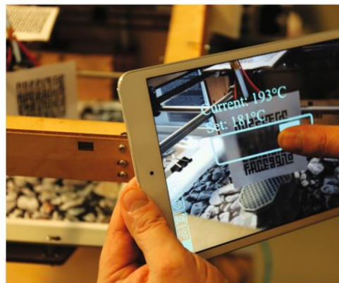
Εικόνα 7.2: Χρήση επαυξημένης πραγματικότητας για έλεγχο της επιφάνειας και της θερμοκρασίας κεφαλής εκτύπωσης (Eiriksson, et al., 2017)
