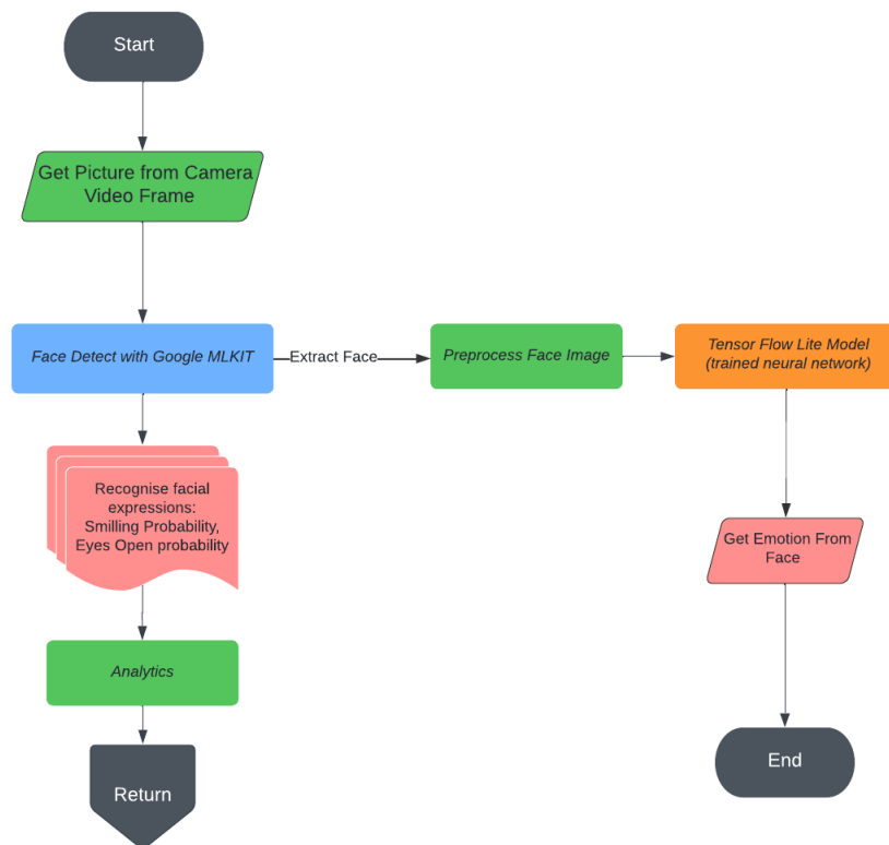
Σχήμα 3.1: Αλγόριθμος εντοπισμού συναισθήματος
