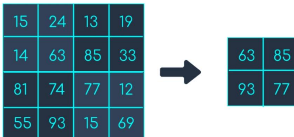
Εικόνα 8 Max pooling με χρήση πίνακα υποδειγματοληψίας 2 X 2 και αποθήκευση σε νέο πίνακα.
