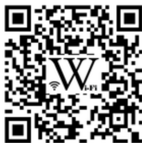
Σχήμα 5.23. Κώδικας QR για αυτόματη σύνδεση σε δίκτυο Wi Fi (Wikipedia).
