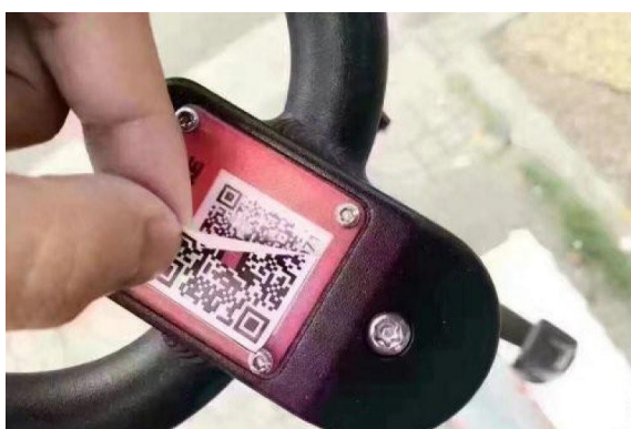
Σχήμα 5.24. Ψεύτικος κώδικας QR κάλυπτε τον πραγματικό κώδικα QR σε ένα κοινόχρηστο ποδήλατο, το οποίο οδήγησε σε απάτη πληρωμής μέσω κινητού (sohu.com).
