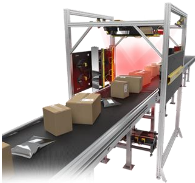
Σχήμα 4.9. Αναγνώστης σταθερής βάσης που διαβάζει το γραμμωτό κώδικα και από τις 6 πλευρές ενός χαρτοκιβωτίου με 99,9% ρυθμό ανάγνωσης. (Cognex - 6-Sided Barcode Reading Tunnels).
