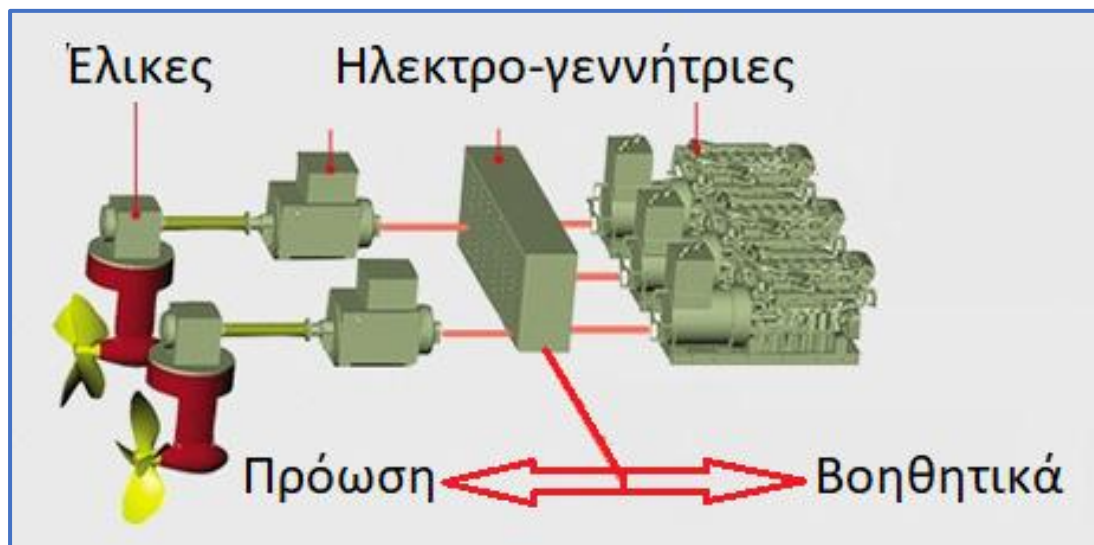
Εικόνα 5: Τυπική διάταξη ηλεκτρο-πρόωσης σύγχρονων κρουαζιερόπλοιων
