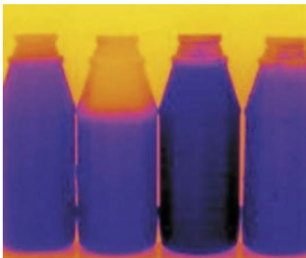
ΕΙΚΟΝΑ: Έλεγχος θερμοκρασίας σε φιάλη με υγρό με κάμερα θερμικής απεικόνισης στα οποία αν κάποιο διαπιστωθεί ότι είναι περισσότερο ή λιγότερο από το επιθυμητό απορρίπτεται. (37)
