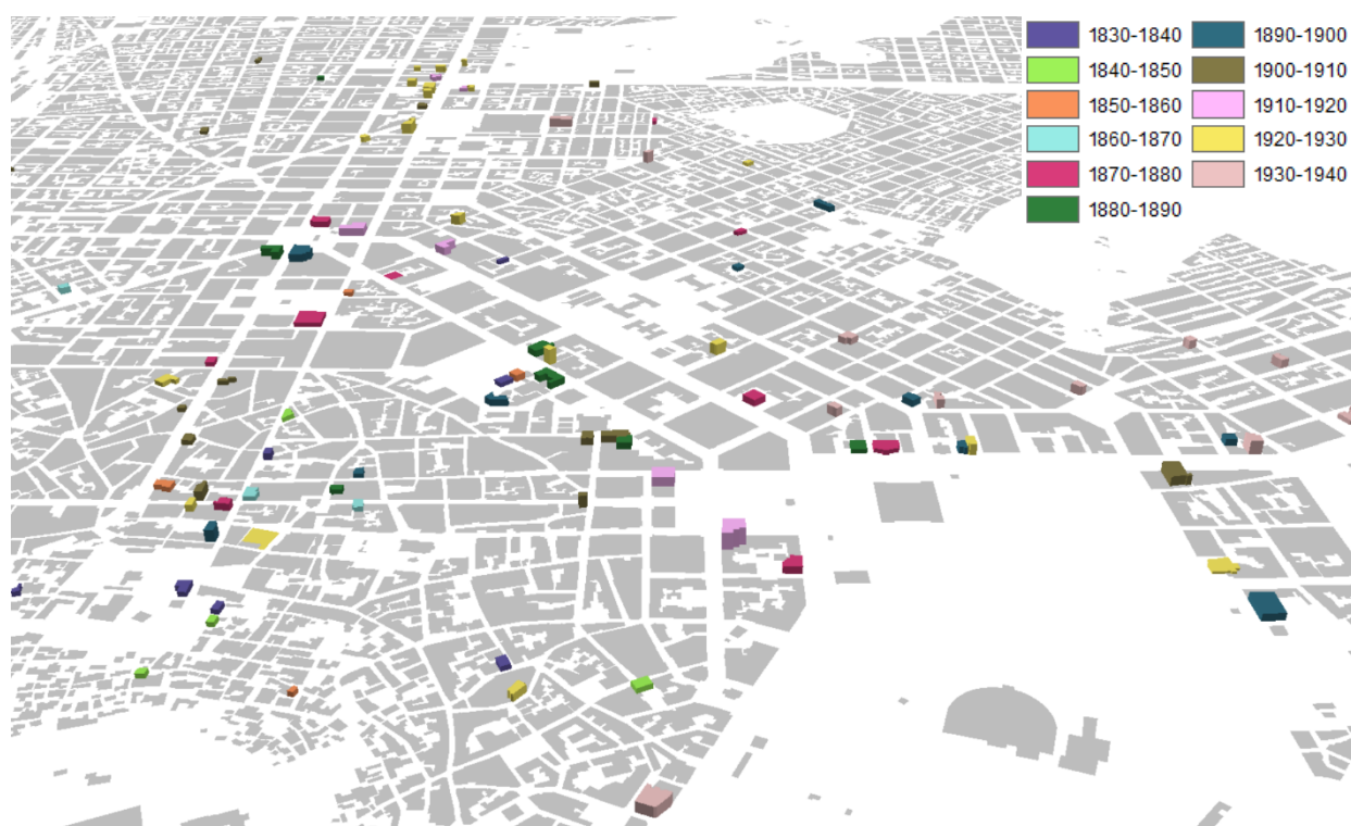
Σχήμα 28. Χάρτης με 3D αναπαράσταση των κτιρίων ανά χρονολογία κατασκευής, για την περιοχή μεταξύ πλατειών Συντάγματος, Ομονοίας και Μοναστηρακίου
