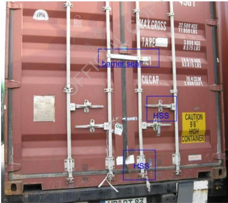
Εικόνα 30: Απεικόνιση τρόπου ασφάλισης εμπορευματοκιβωτίου με την χρήση μπάρας και σφραγίδας HSS (Phillip Morris International, 2018)
