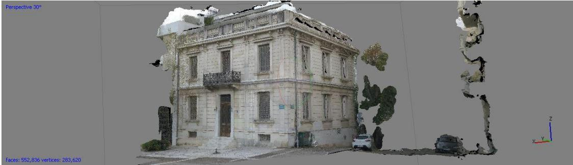
**Εικόνα 29:Μοντέλο φωτογραμμετρίας κατόπιν λήψης φωτογραφιών με drone.**
