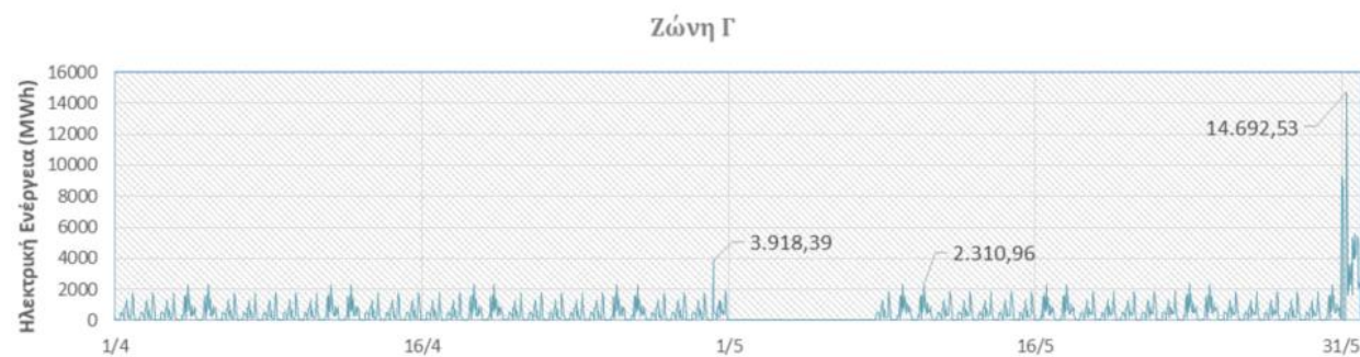
Διάγραμμα Π18. Καμπύλη ηλεκτρικής ενέργειας οικιακού τομέα κλιματικής ζώνης Γ για το διάστημα Απριλίου – Μαΐου στη διάρκεια ενός έτους
