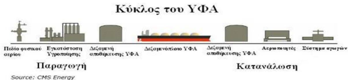
Εικόνα 1: Κύκλος επεξεργασίας ΥΦΑ
