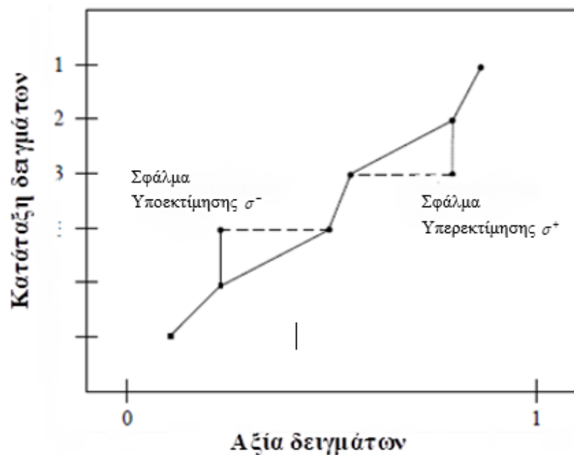
Εικόνα 8 Τα σφάλματα υπερεκτίμησης και υποεκτίμησης της κάθε απόφασης.
